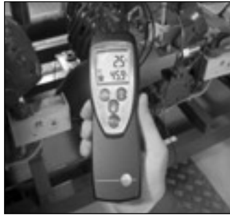
冷蔵システムの過熱温度と過冷却温度とを同時に計測 (testo 922)
