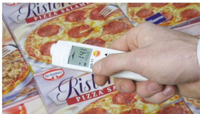
冷凍ケースやフリーザー内部にある食品の表面温度を計測 (非接触式／赤外線計測)
