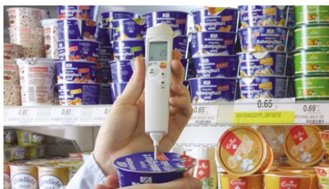
ヨーグルトの中心温度を計測 (接触式計測：testo 826-T3/T4のみ)
