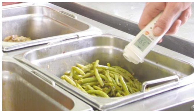
食品を傷つけることなく表面温度を計測 (非接触式／赤外線計測)
