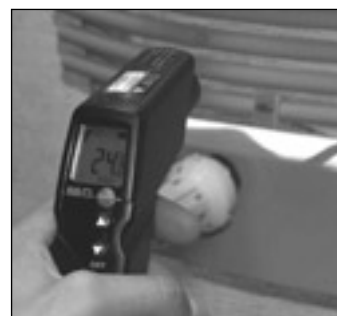
レーザー付なので、計測中のポイントが一目 でわかります
