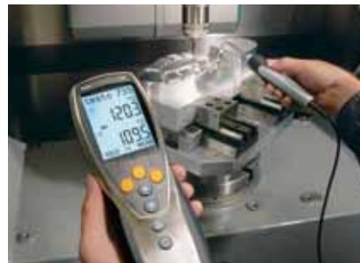
バネ式表面温度プローブは凹凸面も素早く計測
