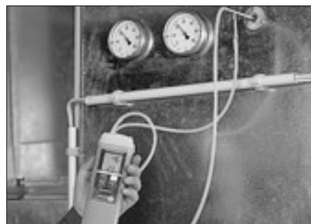
ピトー管を併用して、風速を演算表示
