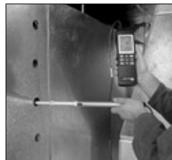
時間平均、ポイント平均計算機能を使用した風速計測
