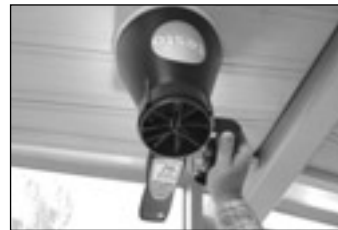
ベンチレータ用ファンネル
