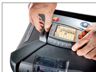
ワンタッチでコントロールユニットの装着
