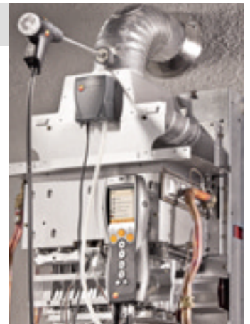
微差圧プローブは背面にマグネット付なので、様々な計測場所に簡単に取り付けられます
