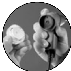
排ガスプローブのフィルタ交換は簡単に行えます
