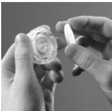
排ガスプローブのフィルタ交換は簡単に行うことができます
