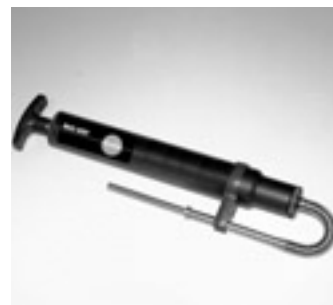
油煙プレート付スモークテスタ 燃焼排ガス中の煤煙(スス)の計測用
