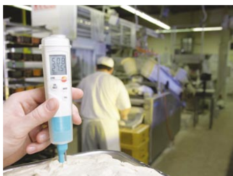
ヨーグルト、チーズなどの半固体製品のpH計測に最適
