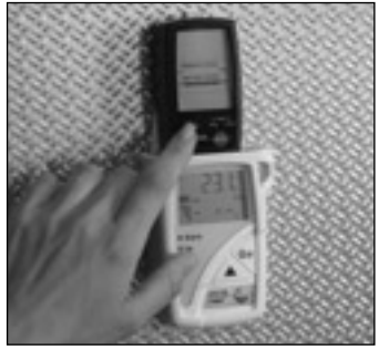
現場で高速データ収集(400データ/秒)し、パソコンでデータ解析 プログラムのストップ/リスタートも行えます
