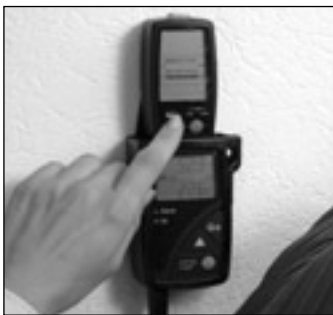
testo 580データコレクタ(オプション)を使ってその場で計測データを取集し、パソコンにダウンロード・分析します
