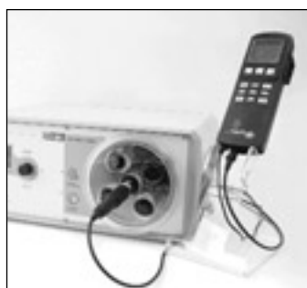
校正済みのtesto 650+高精度温湿度プローブと組み合わせて使用
